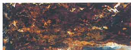
●塩水噴霧試験2500h後の表面外観を比較(めっき付着量:90/90 g/m 2 )
