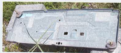
塩害暴露15年8ヶ月後のZAM製室外機底板の外観
