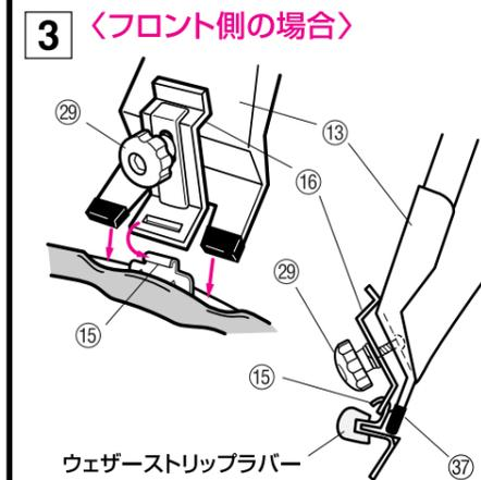
●フロント脚の⑳締め付ノブを緩め、⑯アウタークランプ(前)を引き出し、⑮インナーフックに引っ掛け、⑳締め付ノブを締め付けます。
