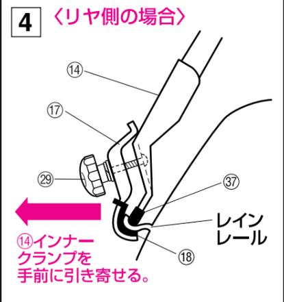
●リア脚の⑳締め付ノブを緩め、⑰アウタークランプ(後)を引き出し、レインレールに引っ掛け、⑭インナークランプを手前に引き寄せながら⑳締め付ノブを締め付けてください。
