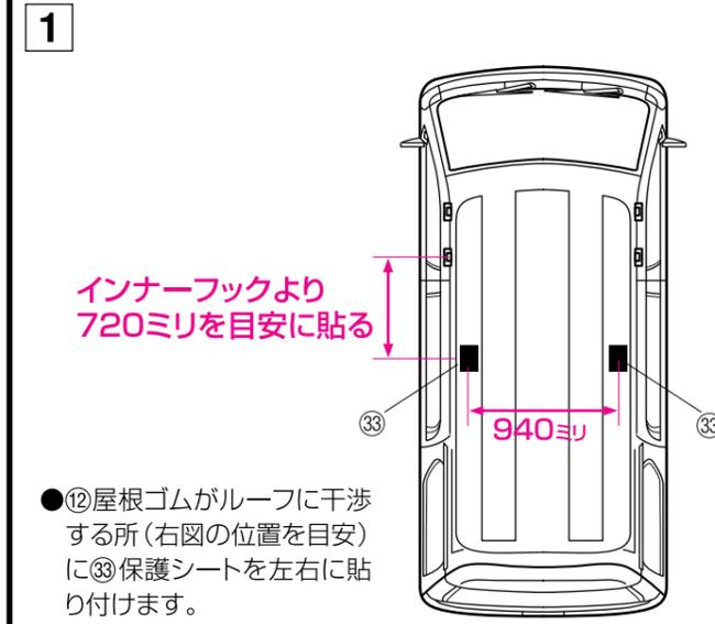
●⑫屋根ゴムがルーフに干渉する所(右図の位置を目安)に⑬保護シートを左右に貼り付けます。
