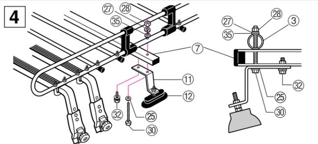
●図のように、⑪脚ステー(センター)と⑫屋根ゴムを組み付け⑪脚ステー(センター)を⑦フレームパイプに⑫六角ボルトセットM6、⑬六角ボルトM6にて仮締めし、コネクターの③パイプ(穴・有)に組付けます。
