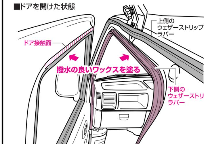
本製品は車両の個体差(バラツキ)によりキャリア装着後、新車や長期保存車などを問わず、フロントドア周りから雨漏りする場合があります。原因として、ドアを閉めっ放しの状態が長く続き、下側のウェザーストリップラバーの硬化にて弾性が低下し、ドア接触面との密着力が弱くなることにより、わずかな隙間でも雨漏りする場合があります。
