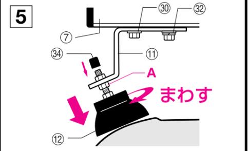
●⑫屋根ゴムをまわしてルーフに密着させ、⑫屋根ゴムに付いているAナットを締め上げ、⑫屋根ゴムを固定します。⑬六角ボルトM6、⑭六角ボルトセットM6をしっかりと締めつけ、⑮安全キャップを⑫屋根ゴムのボルトに取り付けます。
