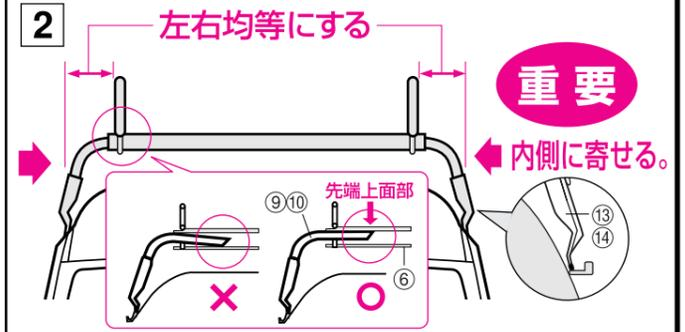
●ルーフにキャリアを載せ、⑬⑭インナークランプをレインレール内側に寄せます。左右の脚ステーが左右均等になるようにして、⑳Uボルトでしっかりと締め付けます。その時、⑨⑩脚ステーの先端上部が⑥フレームチャンネルに密着するようにし、⑬⑭インナークランプがレインレールの内側にあるか確認してください。
