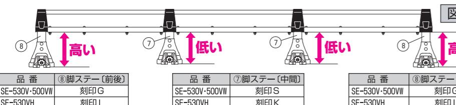
この車両は雨トイが前から後ろに掛けて「山なり」になっている為、なるべくルーフキャリアをフラット(水平)な状態にする為に、中央の脚の高さを敢えて低くしています。
