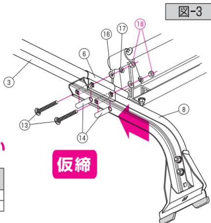
この車両は雨ドイが前から後ろに掛けて「山なり」になっている為、なるべくルーフキャリアをフラット(水平)な状態にする為に、中央の脚の高さを敢えて低くしています。
