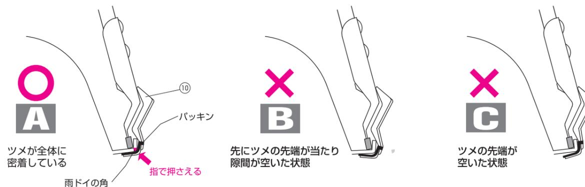
2. 始めに⑩アウターランプにセットしてあるパッキンを外します。〔図-A〕
