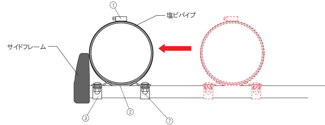
5. 取付け終了後、固定した塩ビパイプを揺すり、しっかりとキャリアに固定されているかの確認を行ってください。ガタツキ等がある場合は再度取付けをやり直してください。
