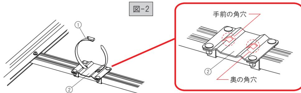
3. ①ホースクランプの輪の中に塩ビパイプを通します。車両の横から見て塩ビパイプの前後の取付け位置を決め、①ホースクランプをマイナスドライバーで仮締めします。(4ヶ所) [図-3]
