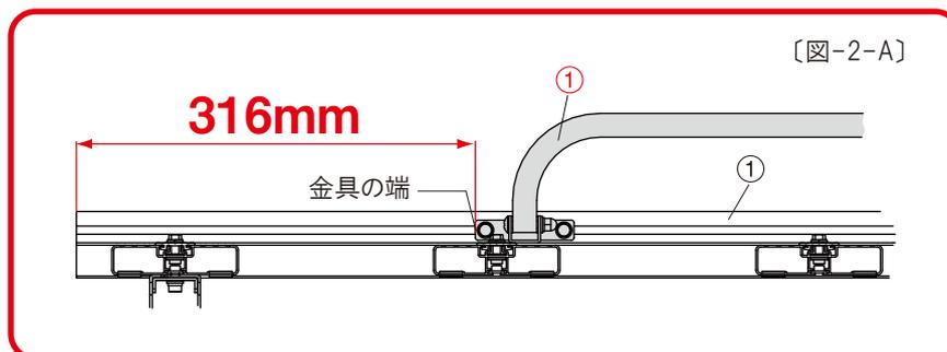
3. 取付け終了後、①サイド可倒パイプセットを揺すり、ガタツキが無いことを確認してください。ガタツキがある場合は再度取付けをやり直してください。
